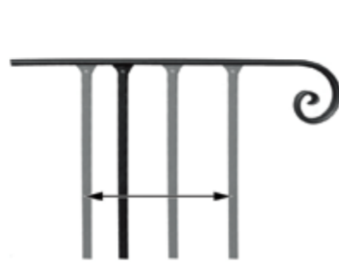
柱の位置を現場に合わせて変えられます。
