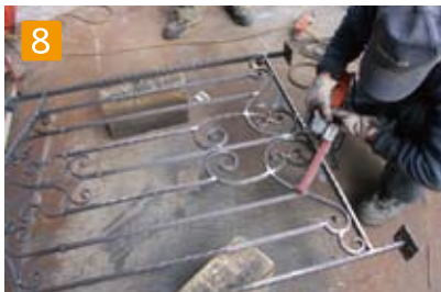
8 溶接部分の荒仕上げ後、更にベルトサンダーで本仕上げをします。
