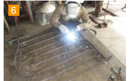
6 寸法等に問題がないか確認してから本溶接します。
