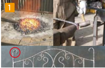
1 ■ 本体上部の「飾り部分」の加工 使用するアイアンパーツをコークス炉で加熱し加工します。
