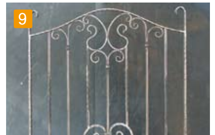
9 ■ 本体の組立てと表面の仕上げを完了 その後、外注先へ塗装依頼 酸洗い→カチオン電着塗装(防錆処理) →アクリル焼付け塗装(上塗)
