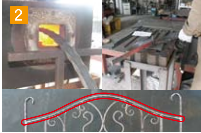
2 ■ 本体「曲線部分」の曲げ加工 使用するアイアンパーツをガス炉で加熱し加工します。
