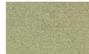
刷毛引き仕上げ
