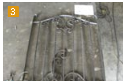
3 製作した本体外枠をもとに製作図面と照合しながら使用パーツを確認します。
