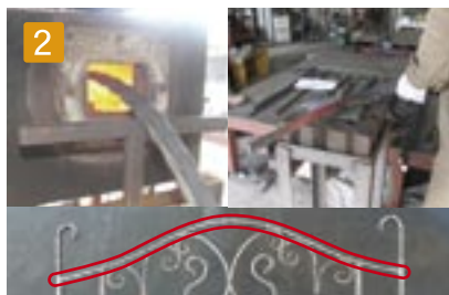
2 ■ 本体「曲線部分」の曲げ加工 使用するアイアンパーツをガス炉で加熱し加工します。
