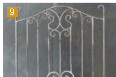
9 ■ 本体の組立てと表面の仕上げを完了 その後、外注先へ塗装依頼 酸洗い→カチオン電着塗装(防錆処理) →アクリル焼付け塗装(上塗)
